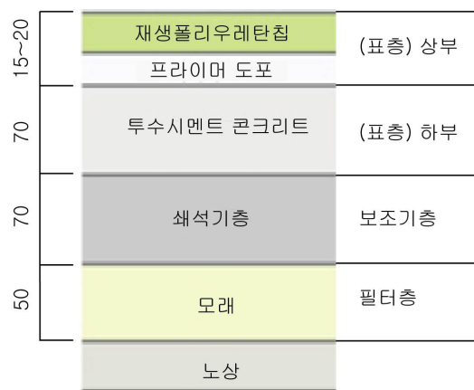
[그림 11] 자전거도로(갈라탄성투수콘크리트)의 구조
